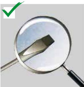
Comprobar el estado de desgaste de las herramientas y cambiar las que están deterioradas.
