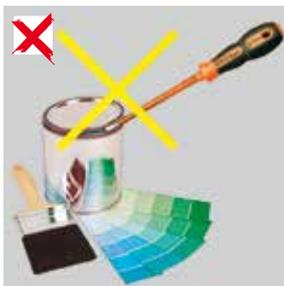
No utilizar como palanca herramientas que no se han diseñado para tal uso, como, por ejemplo, destornilladores, cortafíos, punzones, etc.
