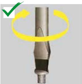
Asegurarse de emplear el destornillador que corresponde a la medida del tornillo y de que la punta de este esté correctamente colocada en la cabeza del mismo.
