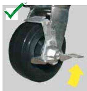
Accionar el freno del carro porta herramienta una vez alcanzada la posición de trabajo deseada.
